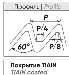
с усиленным хвостовиком и каналом для СОЖ - инструмент для внутренней резьбы
