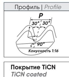
один инструмент для внутренней и внешней резьбы
