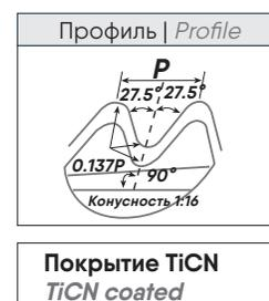
один инструмент для внутренней и внешней резьбы
