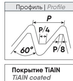
с каналами для СОЖ в каждой канавке – инструмент для внутренней резьбы
