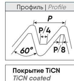
Инструмент для внутренней резьбы | tools for internal threads
